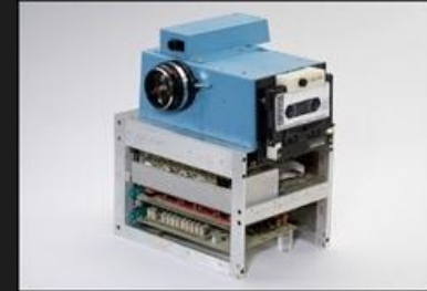
1o Protótipo de Câmera Fotográfica Digital Kodak, 1975
